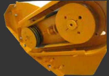
Trois courroies trapézoïdales
